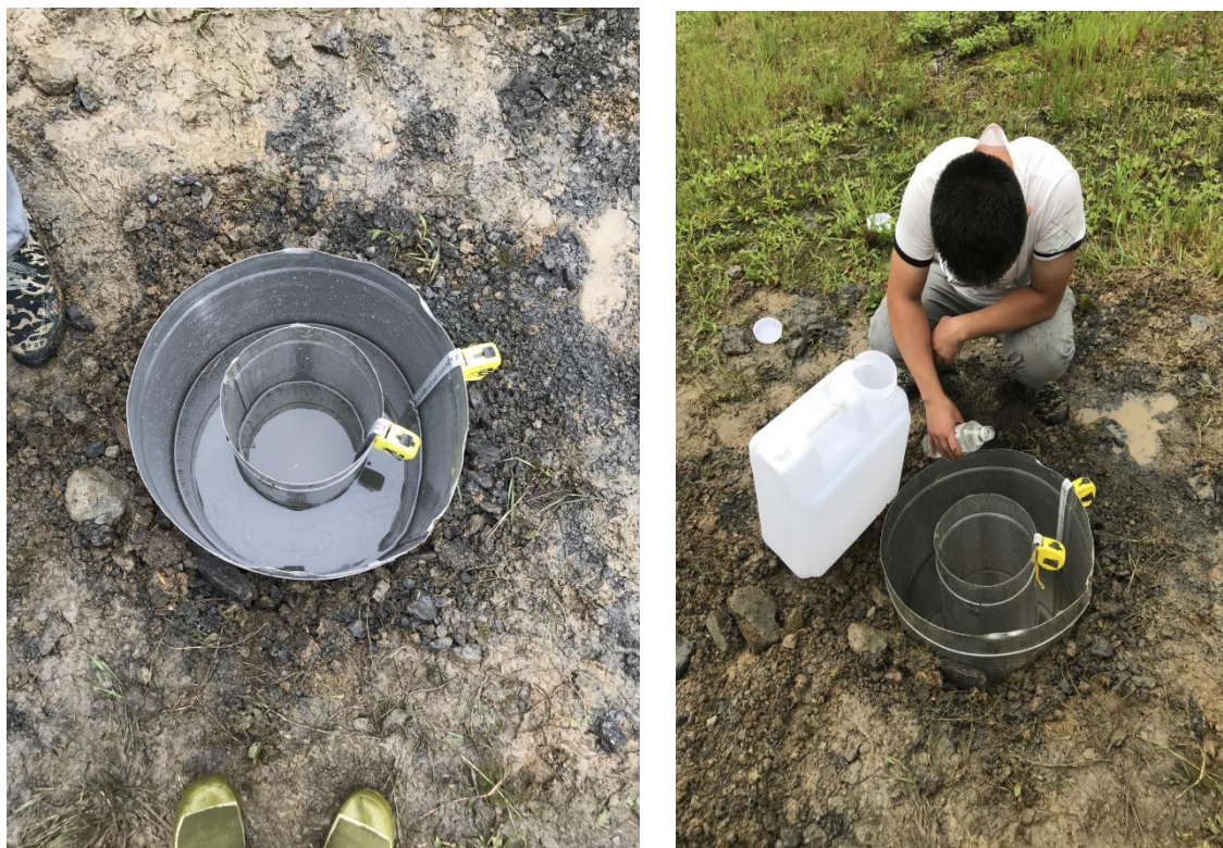
图6.3-1 渗水实验现场照片
